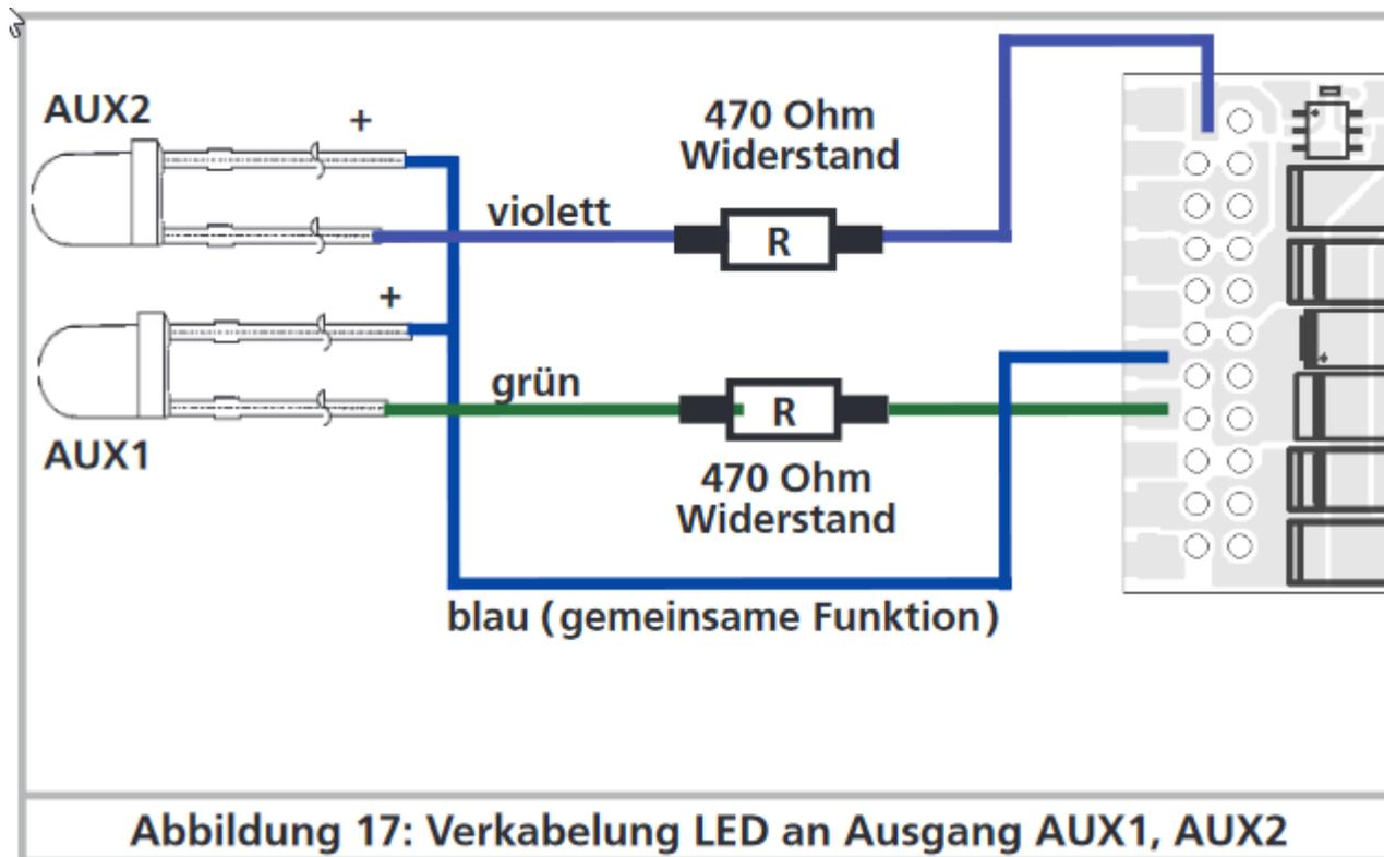
Bei SMD-LEDs wird also wie folgt angeschlossen:
